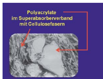
Abb. 2: Superabsorber Kern von SORBION (Model 2009) und Curea P1 (Model 2010)
